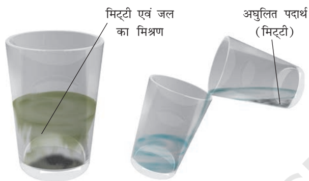
चित्र 3.8 किसी मिश्रण के दो अवयवों को अवसादन तथा निस्तारण द्वारा पृथक करना
