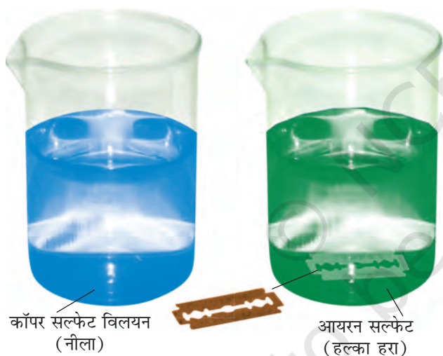
चित्र 5.4 लोहे के साथ अभिक्रिया के कारण कॉपर सल्फेट विलयन के रंग में परिवर्तन
