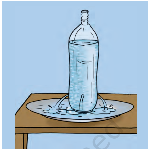
चित्र 8.16 : द्रव बर्तन की दीवारों पर समान गहराई पर समान दाब डालते हैं।
