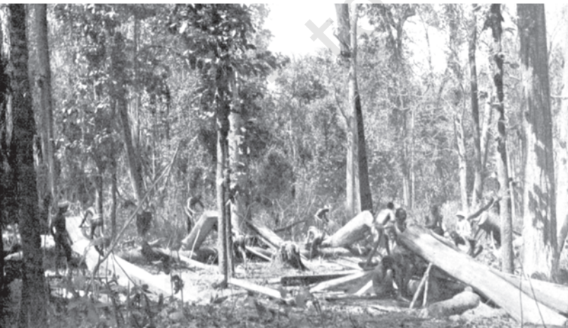
चित्र 3 - सिंहभूम के जंगलों में साल के तनों से 'स्लीपरों' का निर्माण, छोटा नागपुर, मई 1897.
